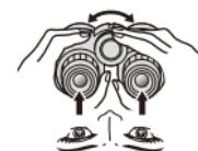
Für ein neues Objekt in unterschiedlicher Entfernung verstellen Sie den Mitteltrieb zur erneuten Schärfeneinstellung.
